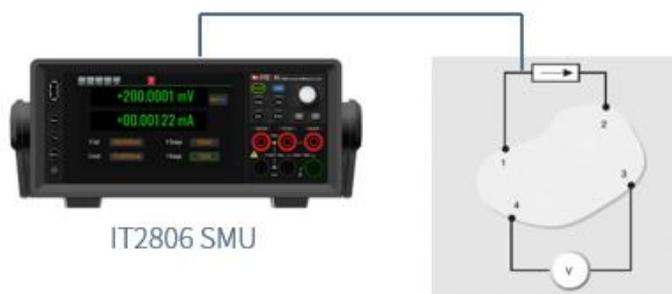
**总结:** 利用 IT2800 系列高精密度源/测量单元可以精准实现半导体薄层电阻的电阻率测试, 为半导体制造工艺的改进提供数据依据。IT2800 SMU 因其高精度测量和丰富的探针台治具优势, 为行业提供专业的测试解决方案。
